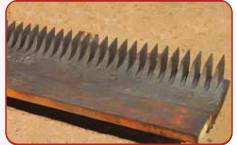
PEINES O RASPADORES EN L FUNDIDOS EN HIERRO GRIS Y ACERO
